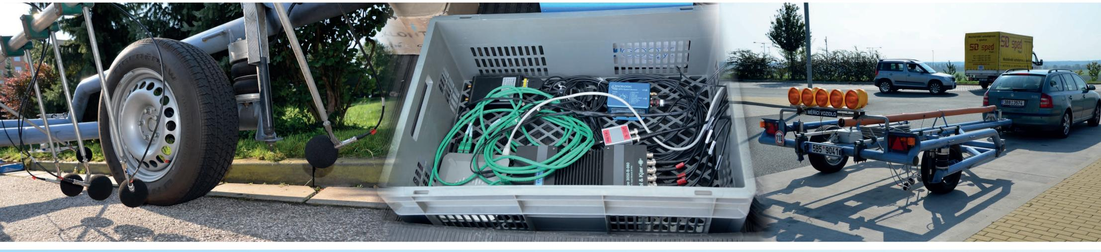
Měření jsou určena k hodnocení hluku styku pneumatiky s vozovkou, jenž jsou dominantní složkou hluku v automobilové dopravě při rychlosti cca 40 km/h a výše.
