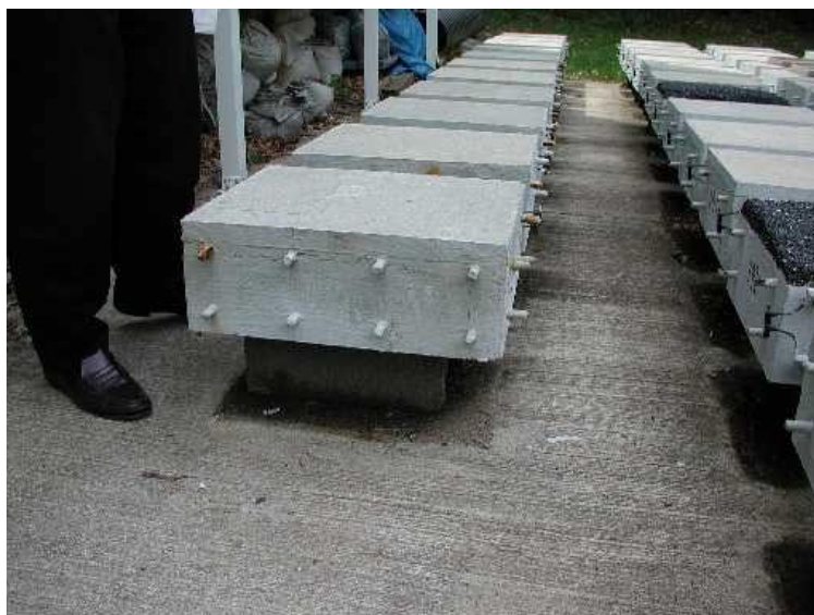
Obr. 2 – Zkušební vzorky přímo pojížděné mostovky
