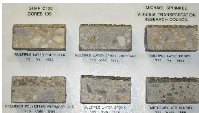
Obr. 3 – Izolace přímo pojížděných mostovek
