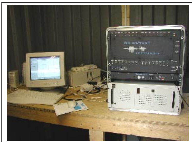
Obr. 5: Šestnácti-kanálová systémová jednotka s počítačem
