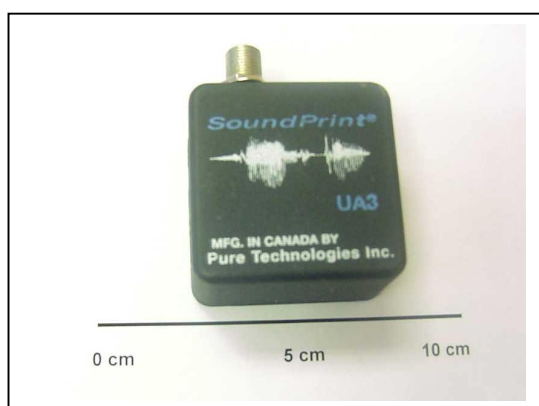
Obr. 2: Piezoelektrický snímač používaný k akustickému monitorování mostů
