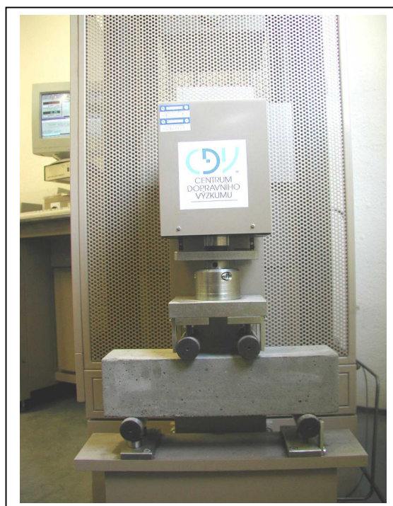
Obr. 10: Dynamické zatěžování zkušební vzorku v laboratoři CDV
