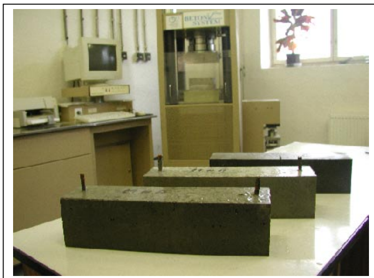
Obr. 9: Zkušební vzorky (trámce 10x10x40 cm)
