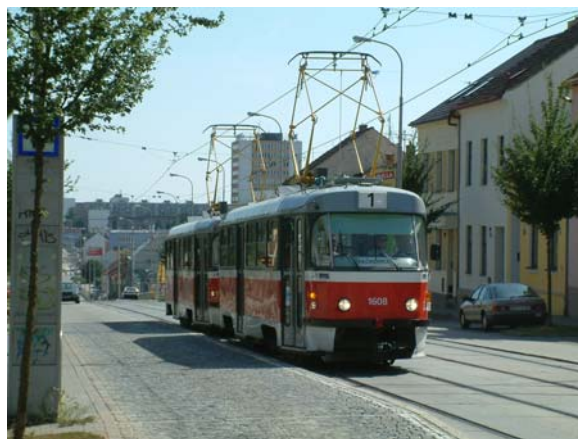
Obr. 17: Zastávka se zvýšenou vozovkou (Brno, ČR)
