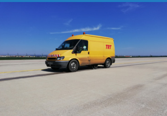
Měření součinitele podélného tření F_p po aplikaci Emulze LO
