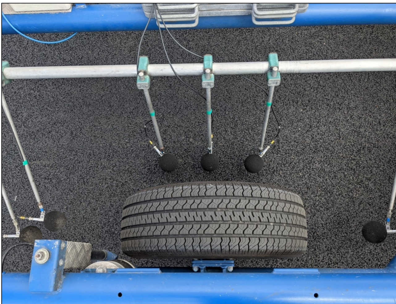
Obrázek 11: Referenční pneumatika s detailem rozmístění jednotlivých mikrofonu v definovaných vzdálenostech.
