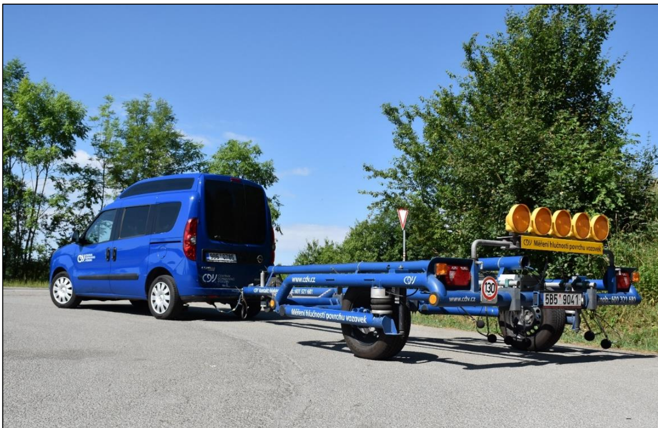
Obrázek 6: Pohled na měřicí soupravu CPX na pozemní komunikaci.
