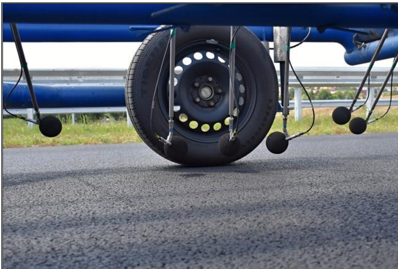
Obrázek 7: Referenční pneumatika s detailem rozmístění jednotlivých mikrofonu v definovaných vzdálenostech.
