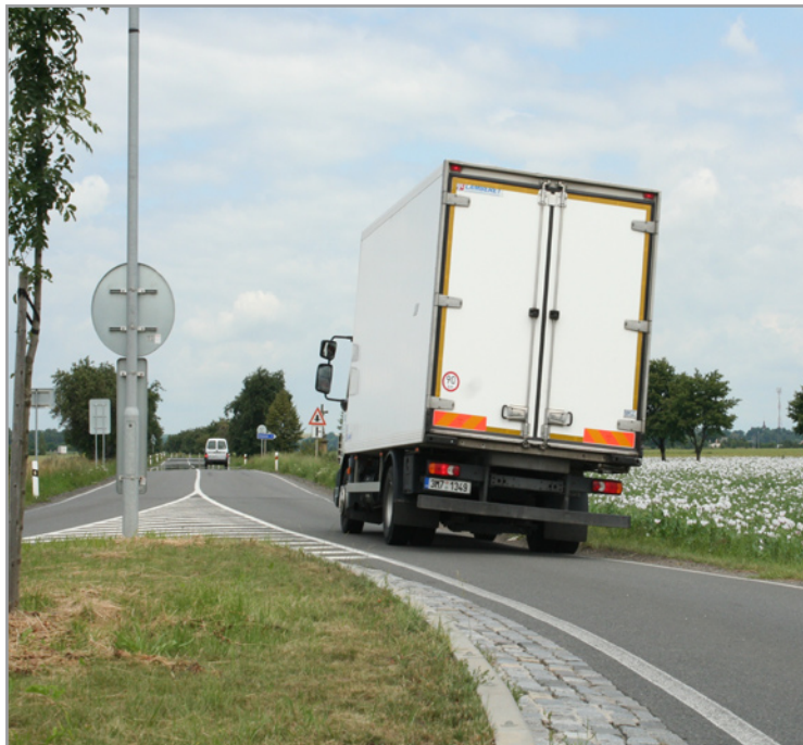
Obrázek 7: Obrázek ukazuje případ projetí nákladního vozu kolem ostrůvku vyšší rychlostí, což má za následek naklonění vozidla
